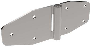
Charnière roulée à usage intensif pour montage avec des vis ou des rivets, idéale pour les véhicules. Les paumelles sont pliées, ce qui permet d'obtenir une surface plane pour le montage, et les sept trous de montage ont un diamètre de 7,0 mm. L'angle d'ouverture est de 180°. L'axe de la charnière est fixe.
